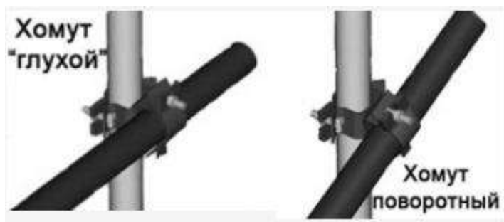
Рисунок 5.2- Схемы крепления элементов в хомутовых лесах
