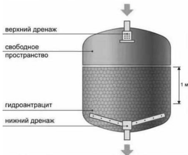
Рисунок 2.1.2 - Напорный однопоточный механический фильтр
