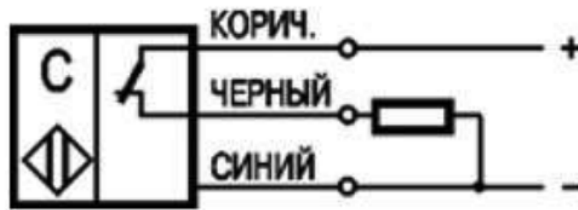
Рисунок 4.2.3 - Схема подключения емкостного датчика CSB A41A5-32P-6-LZ Технические характеристики датчика представлены в таблице 4.2.1.
