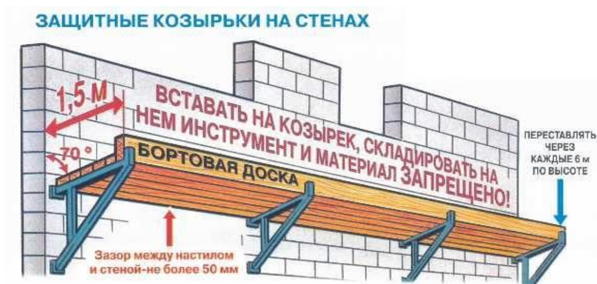
Рис. 4.15 Защитные козырьки на стенах
