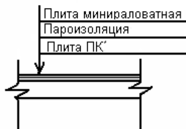
Рисунок 14-Схема сбора нагрузок на плиту чердачную
