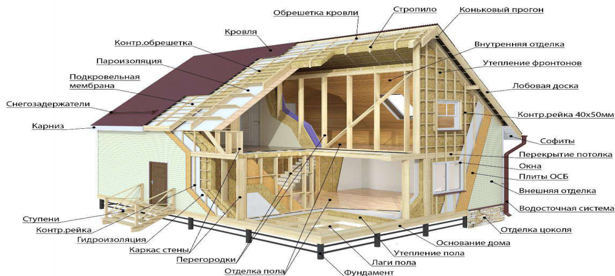
Рис. 27.1 Устройство каркасно-щитового здания [35]
