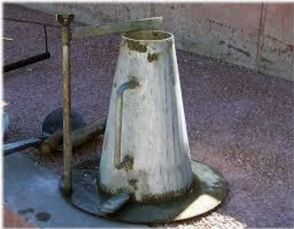
Рисунок 2. Конус для измерения осадки конуса бетонной смеси.
