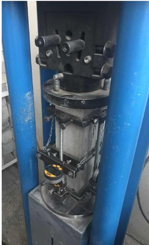
Рисунок 29 - Испытание на сжатие
