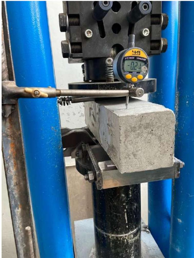
Рисунок 31 - Испытание на изгиб.
