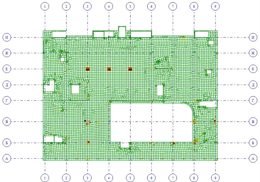
Площадь поперечной арматуры на 1м<sup>2</sup> при шаге 100 см; максимум в элементе 24258
