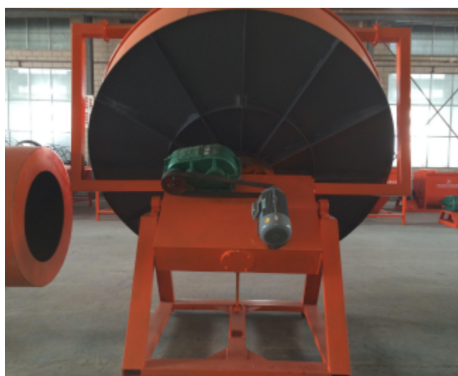
Рисунок 12 -Тарельчатый/дисковый гранулятор диаметр 4,5 м
