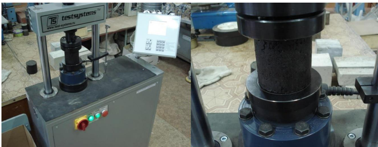
Рисунок 2.2 – Электромеханический пресс ДТС 06-50/100
