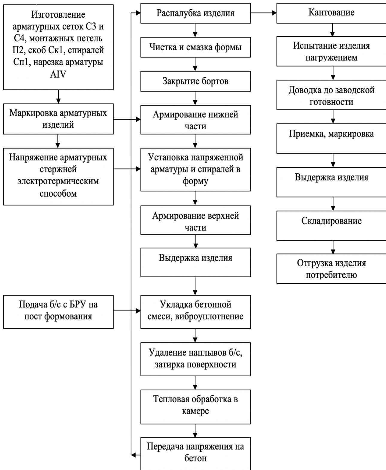
Рисунок 8 – Технологическая схема производства предварительно напряженных дорожных плит 1П60.18АIV
