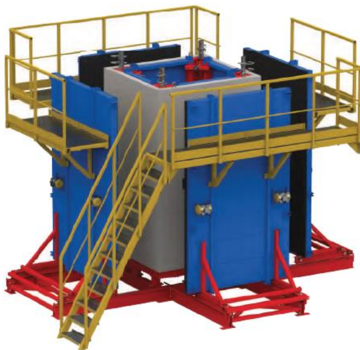
Рисунок 13 – Щиты наружной опалубки с подвижной кареткой
