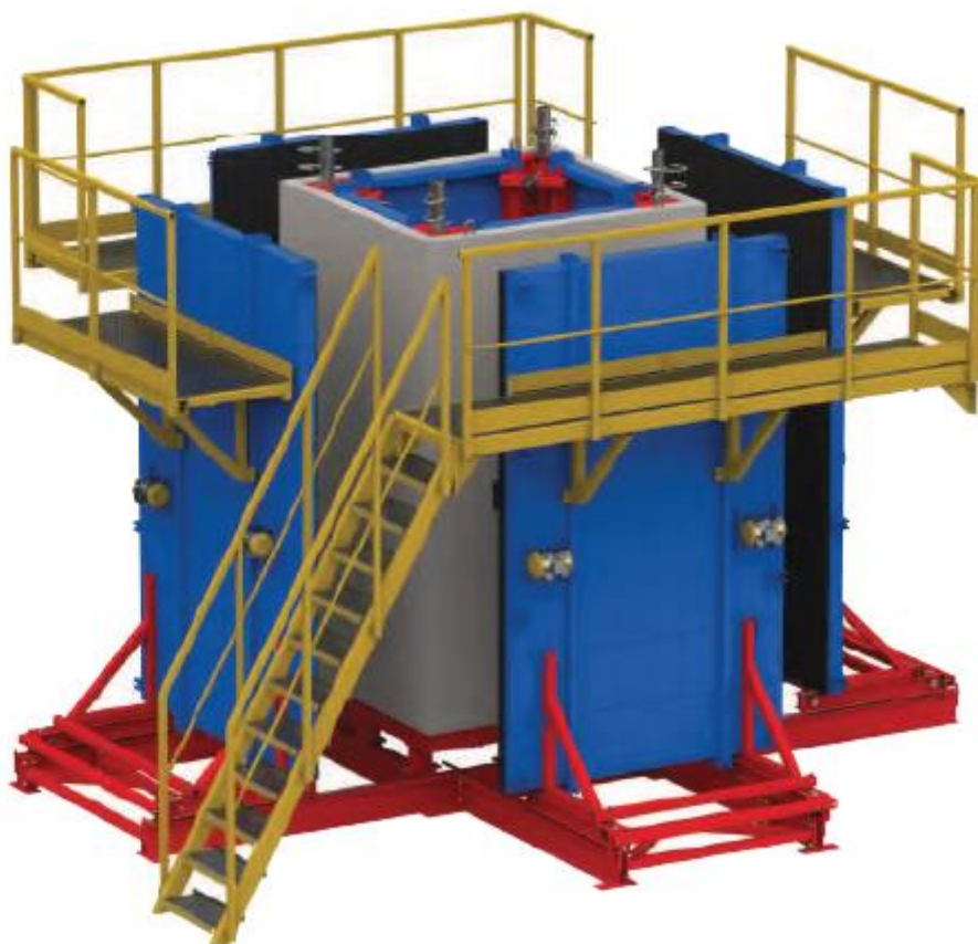
Рисунок 28 – Щиты наружной опалубки с подвижной кареткой
