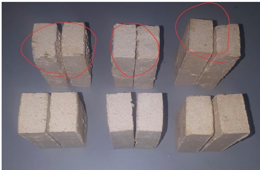
Рисунок 18 - Влияние различного процента добавок мела на выветривание
