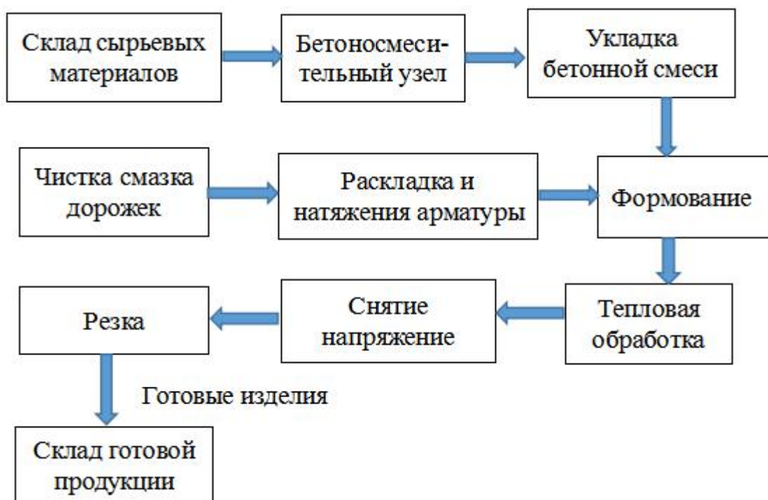
Рисунок 2 – Технологическая схема производства железобетонных многопустотных плит перекрытий
