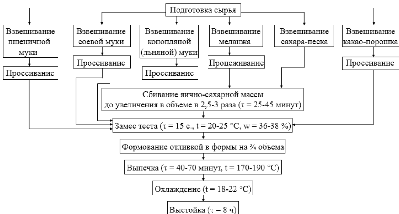
Рисунок 3.7 – Технологическая схема приготовления бисквитного полуфабриката (образец 3 и образец 5)
