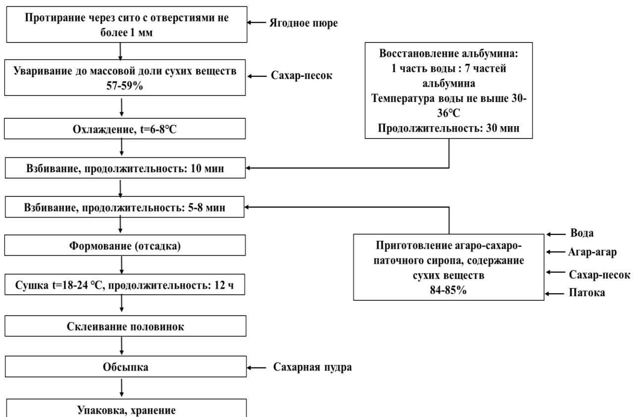
Рисунок 3.2 – Технологическая схема производства зефира на сухом альбумине
