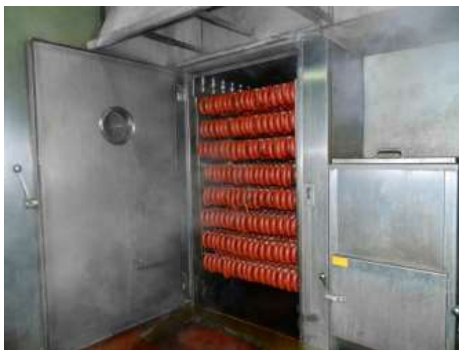
Рисунок 8 – Вакуумная сушилка КВСК
