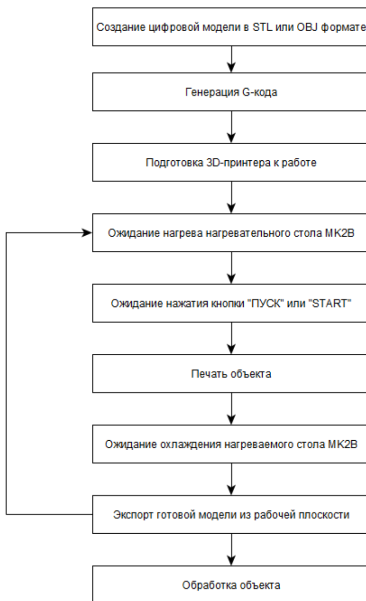
Рисунок 32 – Блок-схема алгоритма работы 3D-принтера без применения на нем автоматизации
