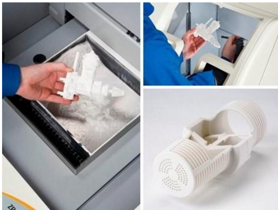
Рисунок 12 – Струйная трехмерная печать
