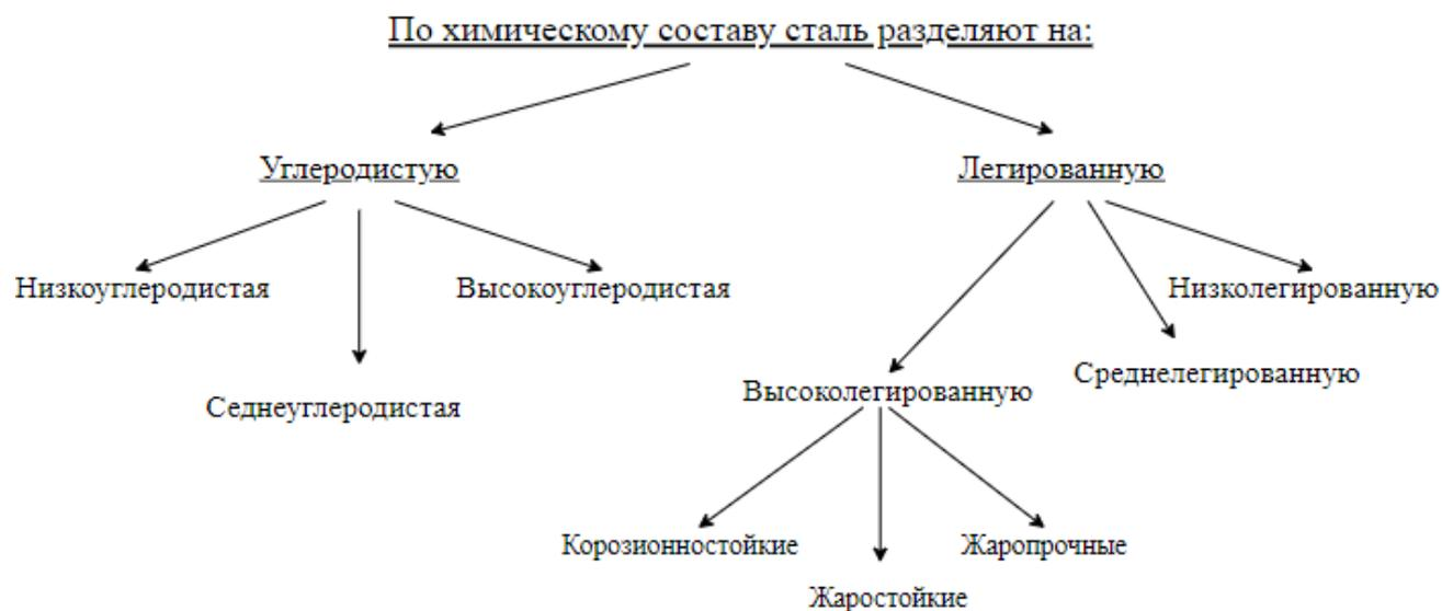
Рисунок 1.1 – Классификация стали по химическому составу
