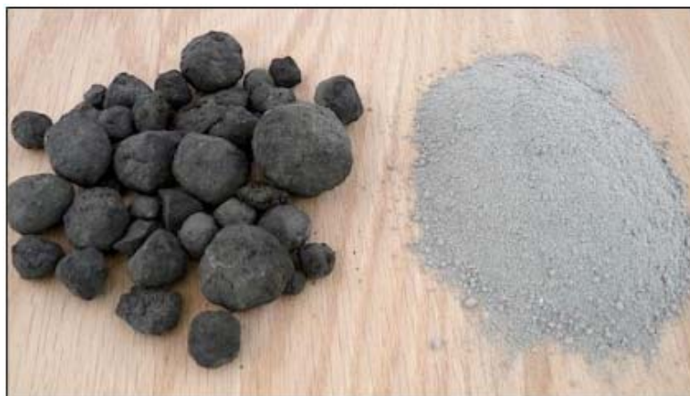
Рисунок 1.4. Клинкер (слева) и готовый цемент (справа)
