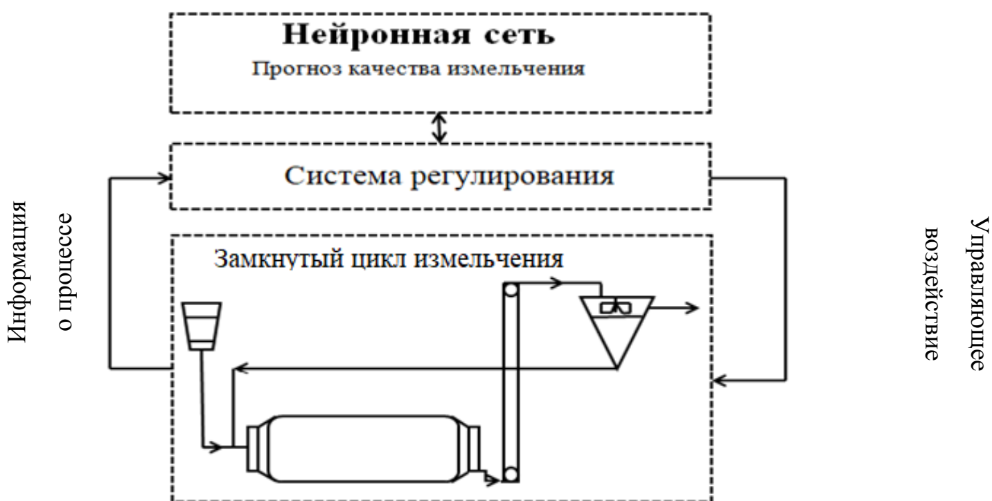
Рисунок 2. Структура системы управления процессом помола замкнутого цикла
