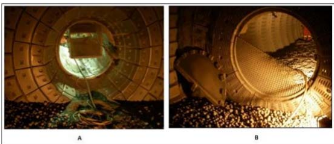
Рисунок 1.5. Двухсекционная трубчатая шаровая мельница. А- отсек 01, В- отсек 01/02 и разделительная диафрагма.
