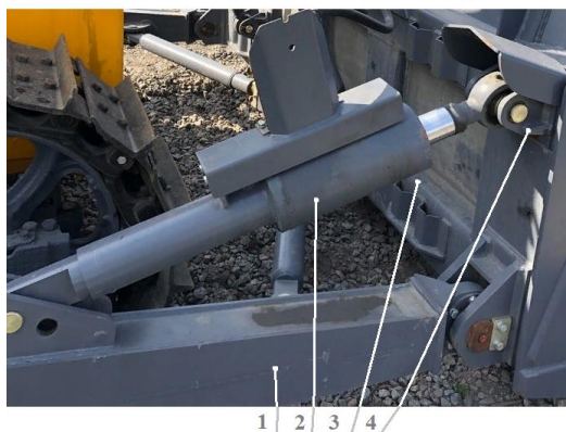
Рисунок 1.17 – Соединение зеркала отвала с гидроцилиндром перекоса
