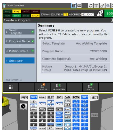
Рисунок 2.10 – Создание программы для детали ТМ.10.5219.080 СБ «Кронштейн»
