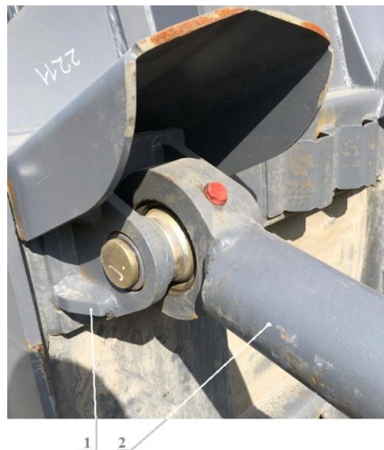
Рисунок 1.16– Соединение зеркала отвала с боковой тягой
