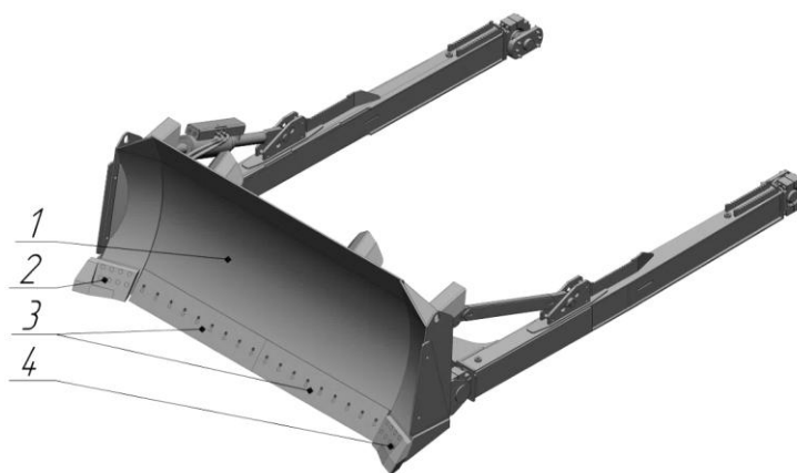
Рисунок 1.7 – Конструкция бульдозерного отвала вид спереди
