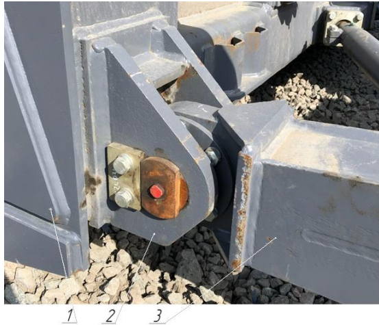
Рисунок 1.15 – Соединение зеркала отвала с брусом толкающим
