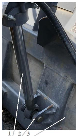
Рисунок 1.18 – Соединение зеркала отвала с гидроцилиндром подъема отвала правая сторона
