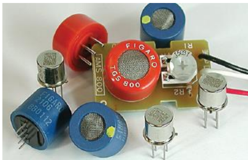
Рисунок 1 - Датчики газа от компании Figaro
