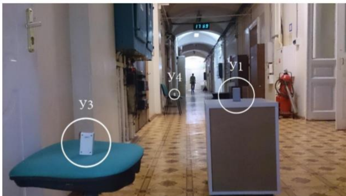
Рисунок 11 – Расположение приемопередатчиков в эксперименте с изменяемой топологией сети
