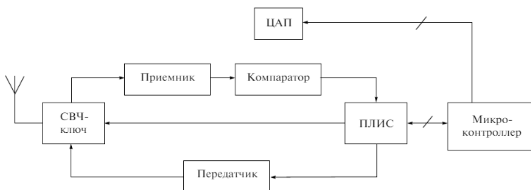
Рисунок 5 – Структурная схема приемопередатчика ППС-43
