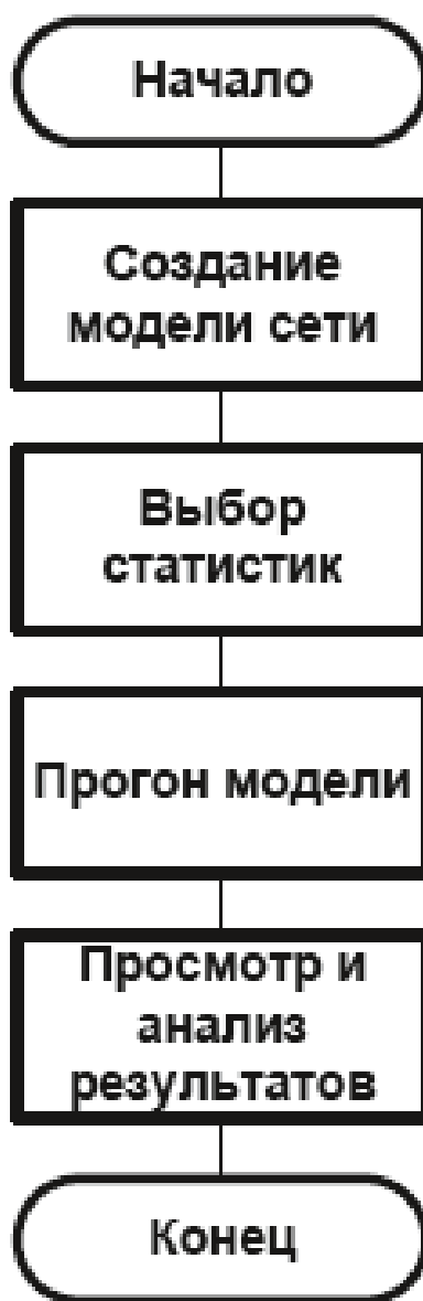
Рисунок 2.2 – Порядок работы с пакетом программ RiverbedModeler
