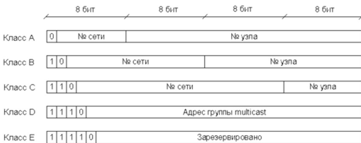
Рисунок 1.5 – Состав адресов протокола четвертой версии
