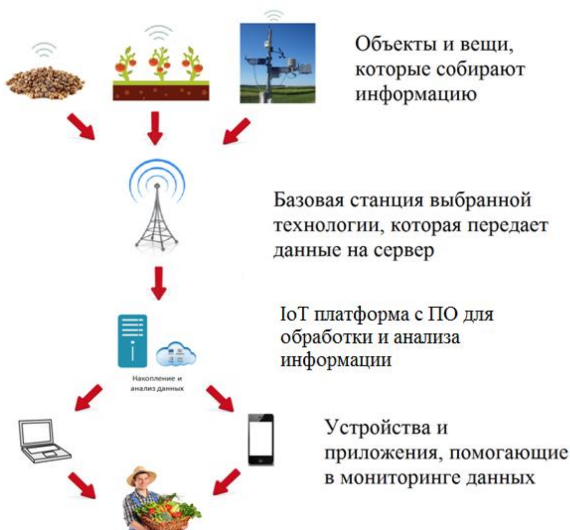
Рисунок 2 — Архитектура проекта SMART-АГРО
