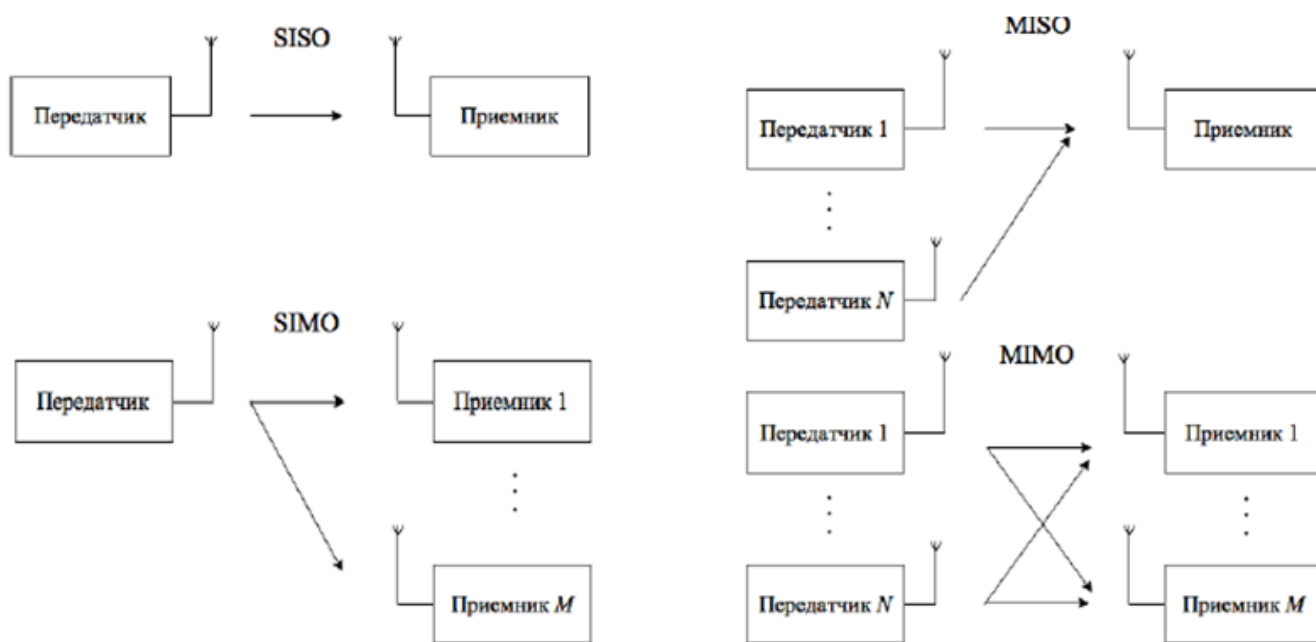
Рисунок 1.5 – SISO, SIMO, MISO и MIMO конфигурации систем связи
