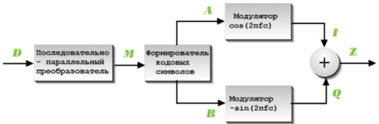
Рисунок 2.2 – Структурная схема формирователя QAM модулированного сигнала
