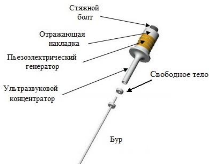
Рисунок 1.2 – Устройство ультразвукового бура
