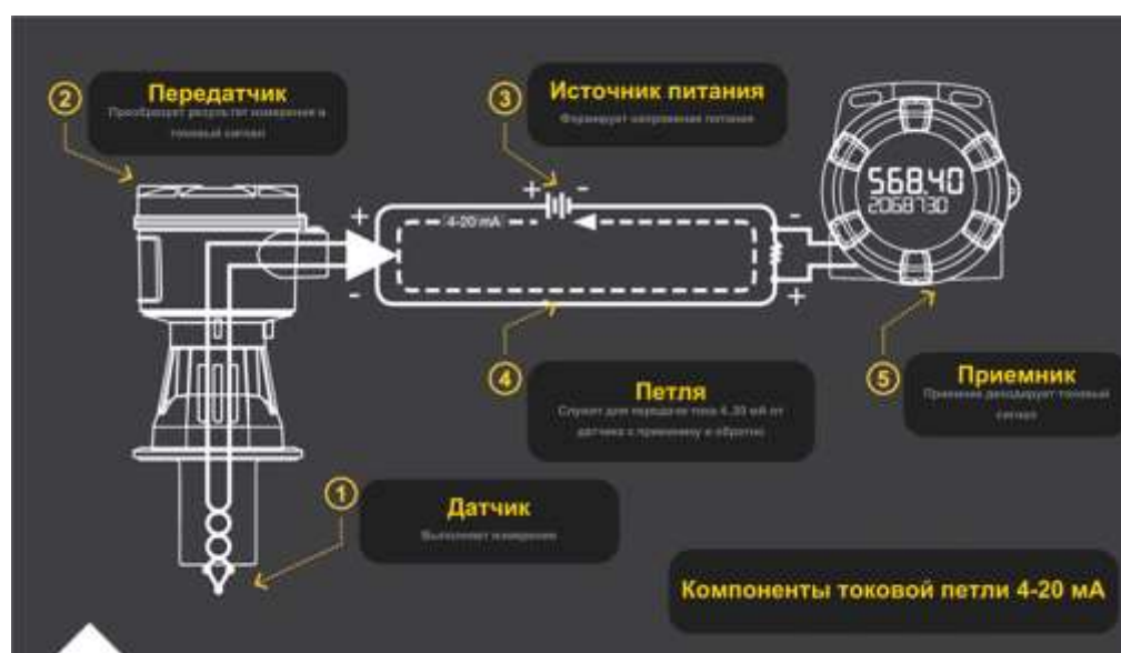
Рисунок 2.1 – Компоненты токовой петли 4-20мА
