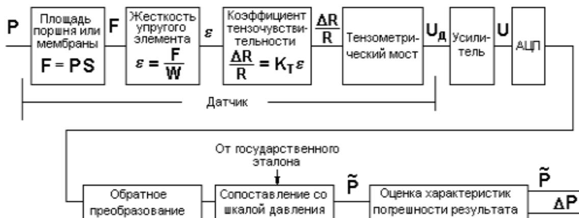
Рисунок 4.10 – Схемы преобразования для тензорезистивного датчика давления
