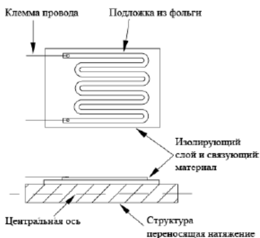
Рисунок 1.10 – Пример связанного тензодатчика
