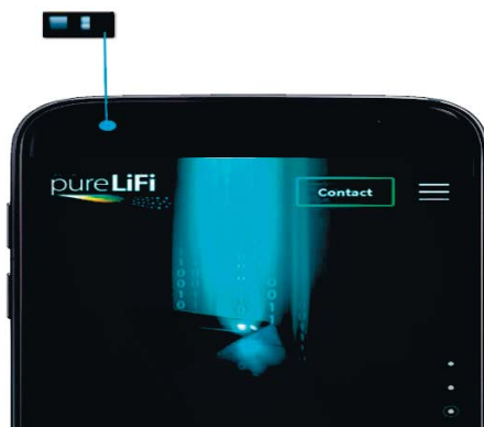
Рисунок 5 – Интегрированный приемопередатчик Gigabit LiFi для мобильных устройств
