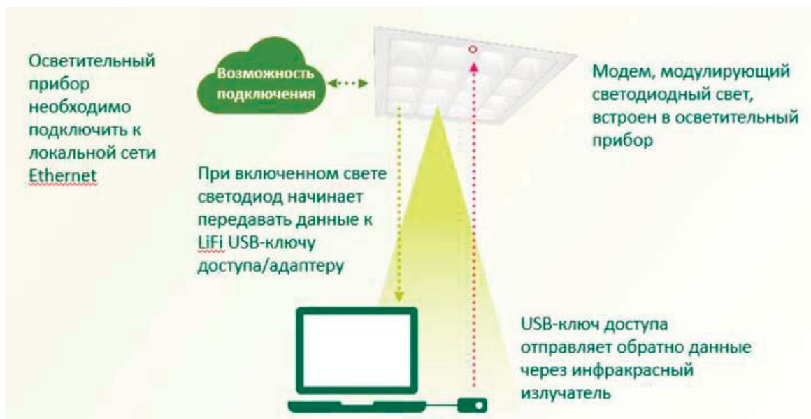
Рисунок 6 – Организация системы Li-Fi для доступа в Интернет от Signify
