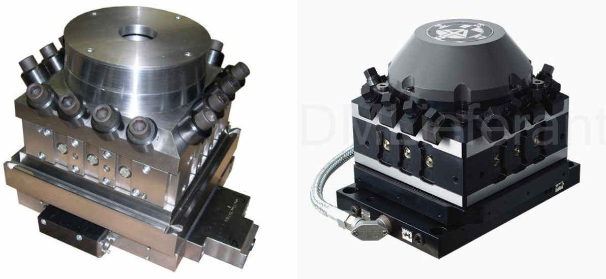
Рисунок 3.1 – Револьверные головки с вертикальной осью
