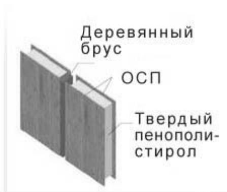
Рисунок 2.3 – Деревянная «сэндвич» – панель «ЭКОПАН»
