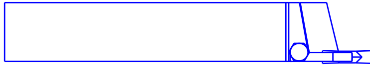
Рисунок 16 – Резец с СМП для обработки канавок
