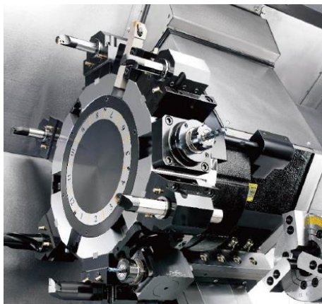
Рисунок 11 – Приводная инструментальная головка
