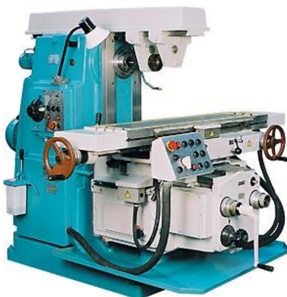
Рисунок 5 – Широкоуниверсальный консольно-фрезерный станок 6P82Ш
