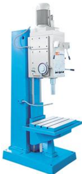
Рисунок 6 – Вертикально – сверлильный станок 2Н125
