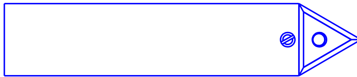
Рисунок 17 – Резец с СМП для нарезания наружной метрической резьбы
