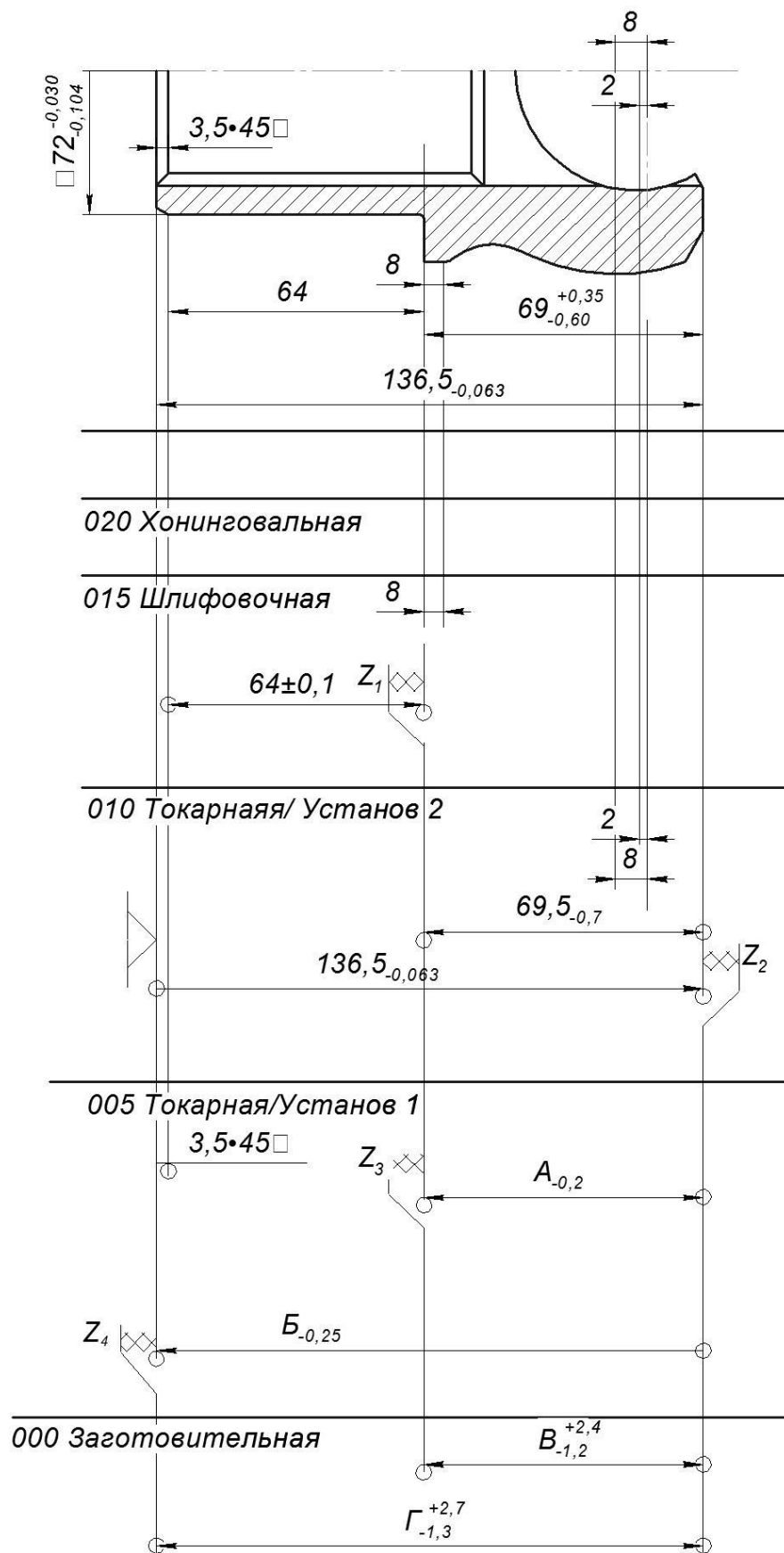
Рисунок 2.32 – Размерный анализ в линейном направлении
