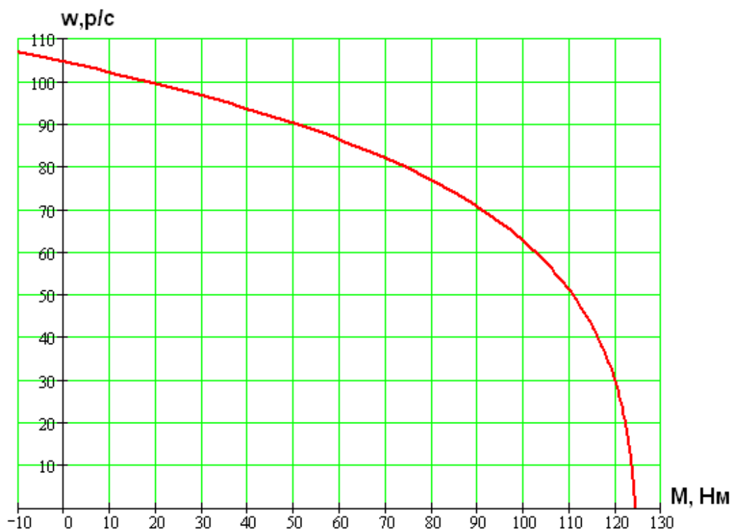
Рисунок 7.1 – Естественная характеристика механического двигателя
