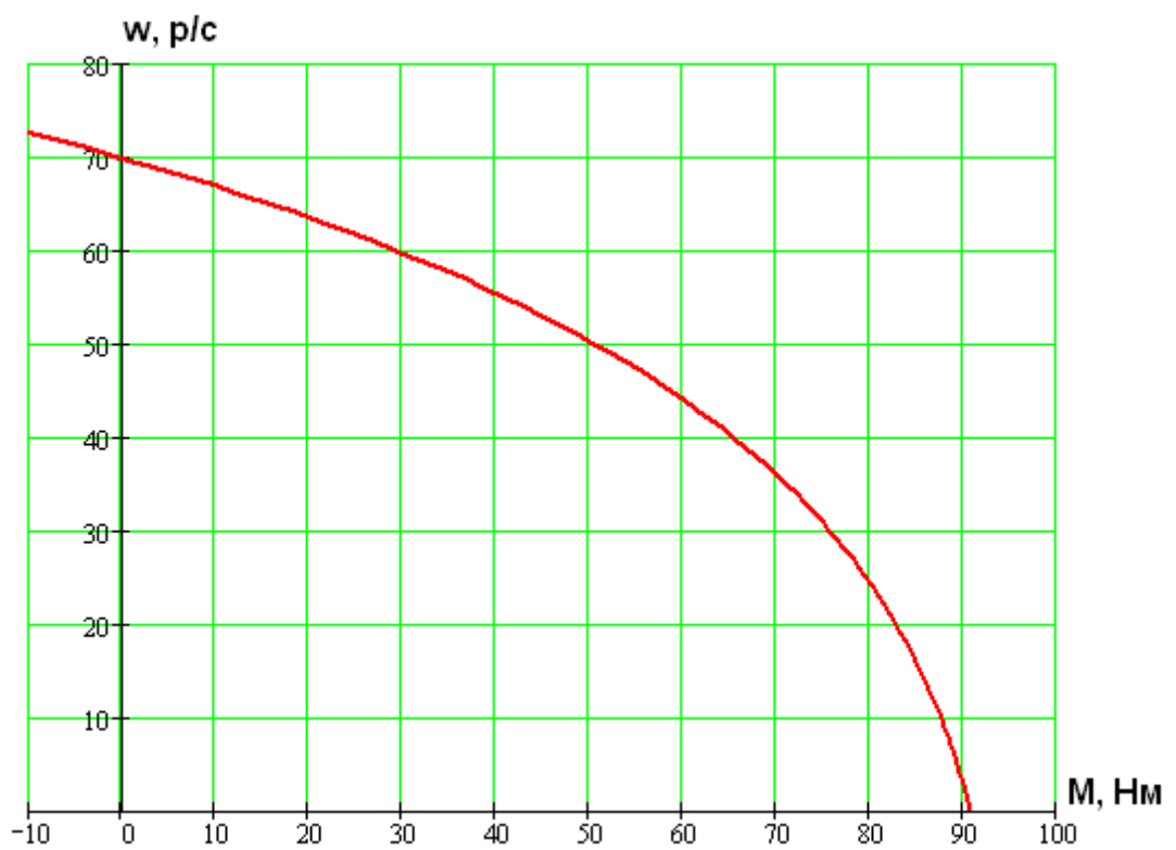
Рисунок 7.3 – Механическая характеристика, проходящая через заданную точку, при движении с грузом
