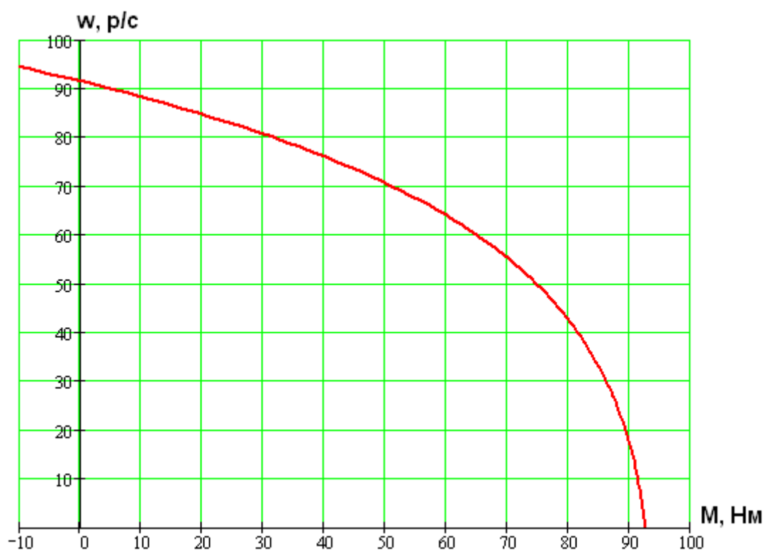
Рисунок 7.5 – Механическая характеристика, проходящая через заданную точку, при движении без груза
