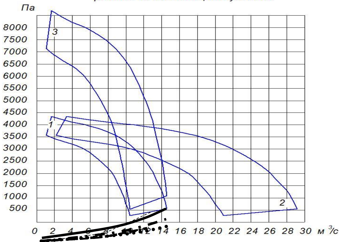
Аэродинамические характеристики ВМ-8-01 при одиночной (1), параллельной (2), последовательной (3) работе на вентиляционную сеть
