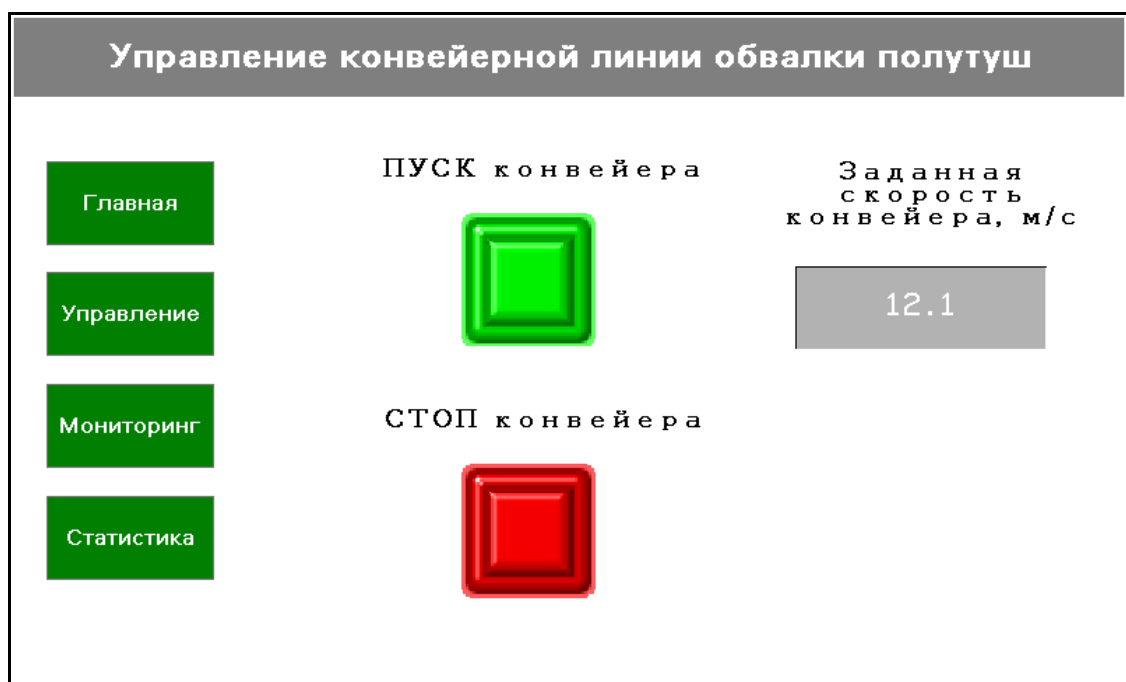
Рисунок 6.10 – Интерфейс сенсорной панели страницы «Управление»
