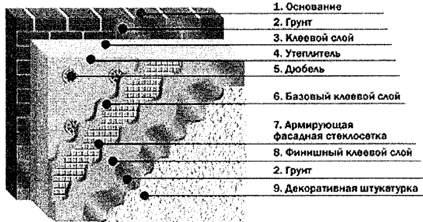
Рисунок 9 – Схема фасадной изоляции с тонким штукатурным слоем.
