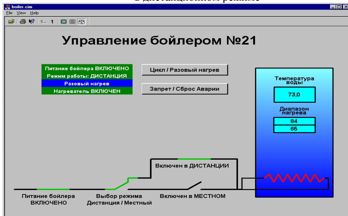
Рисунок 14 – Видеодиаграмма разового нагрева бойлера в дистанционном режиме
