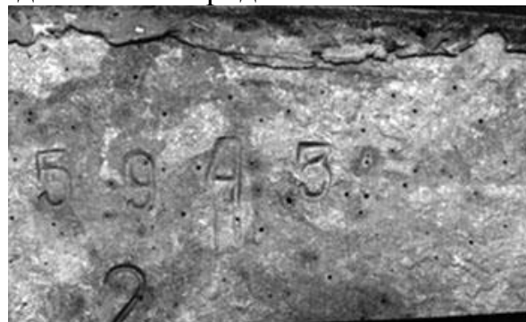
Рисунок 9 – Поверхность сортовой заготовки, пораженная газовыми пузырями
