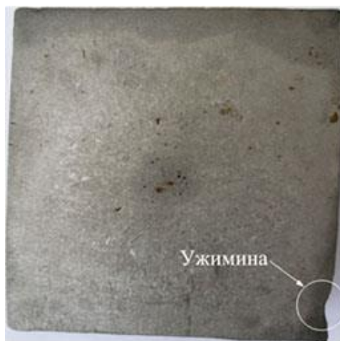
Рисунок 7 – Поперечное сечение сортовой заготовки с ужиминной в правом нижнем углу
