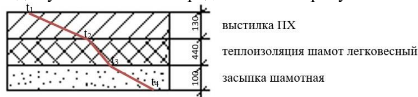
Рисунок 5.2 – Футеровка пода туннельной печи
