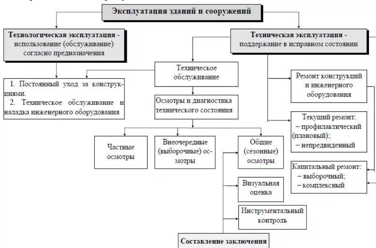
Рисунок 7 – Система технической эксплуатации, ремонта и реконструкции здания
