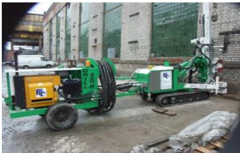
Рисунок 12 – Среднегабаритные буровая установка Drill 450B
