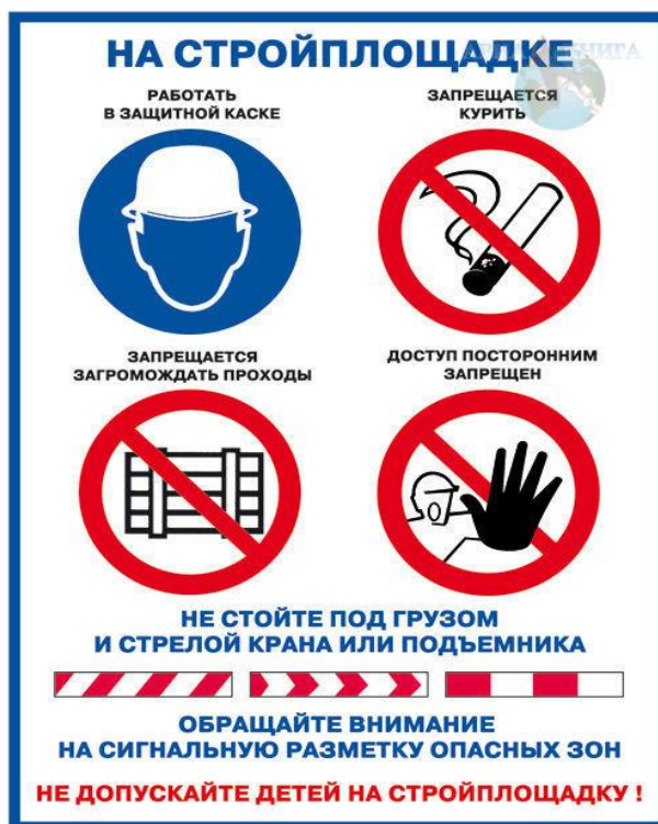
Рисунок 15 – Запрещающие знаки на стройплощадке.
