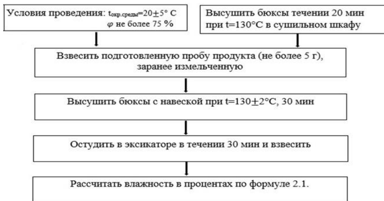
Рисунок 8 – План исследования определения массовой доли влаги
