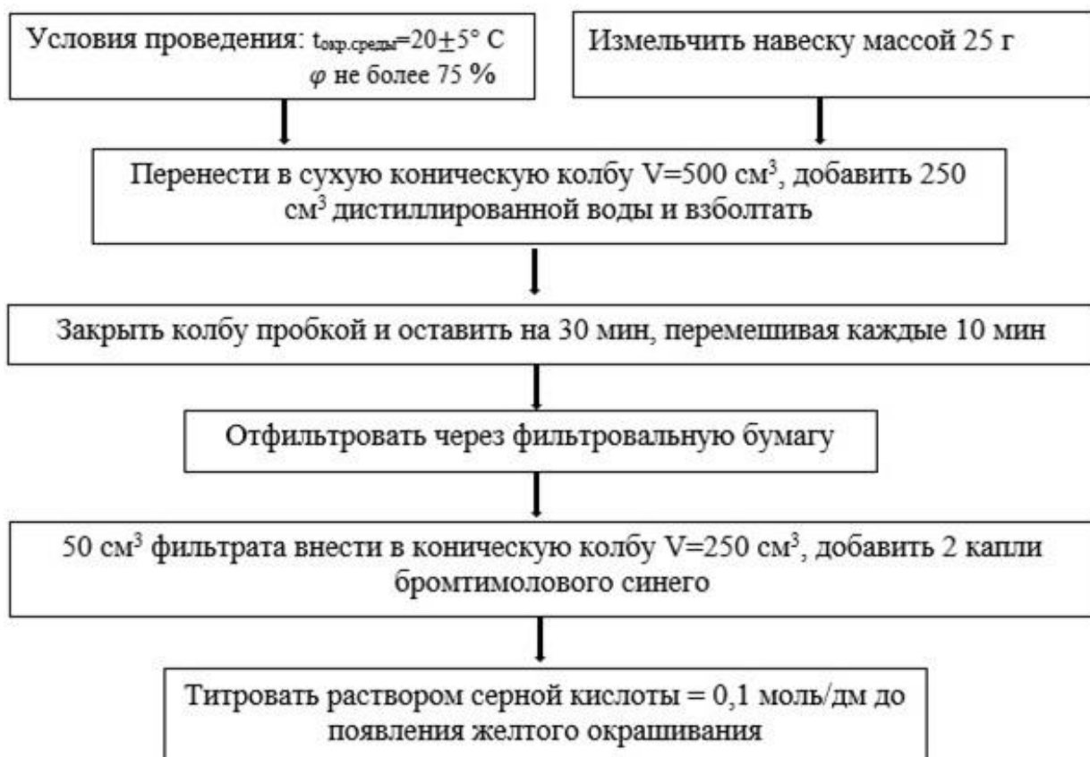
Рисунок 9 – План проведения исследования на определение щёлочности
