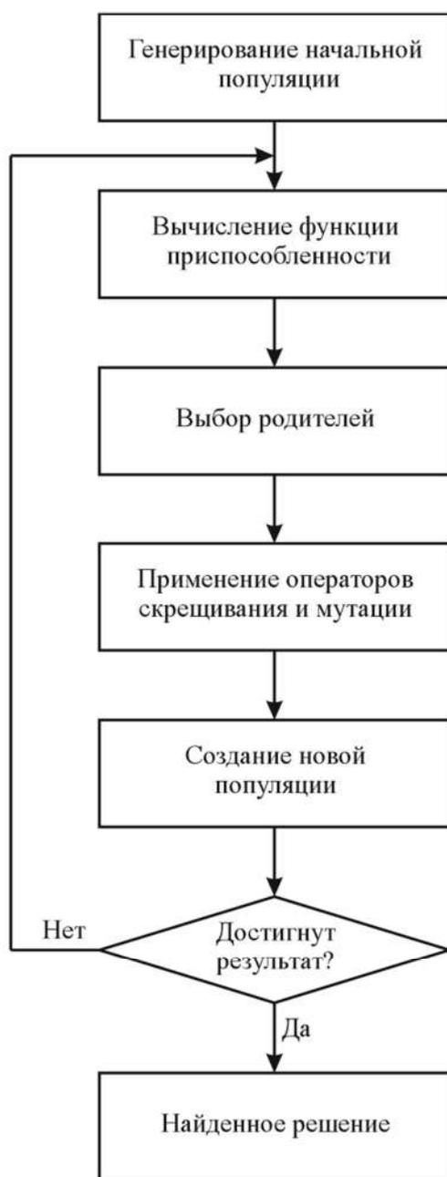
Рисунок 1.8 – Блок-схема генетического алгоритма
