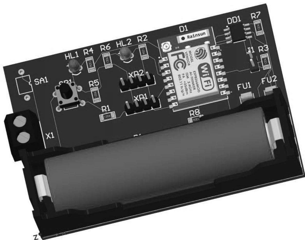
Рисунок 3.9 – 3D вид печатной платы с встроенным аккумулятором 18650
