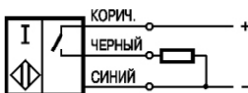
Рисунок 10.3 – Схема подключения датчика ISB AF8A
