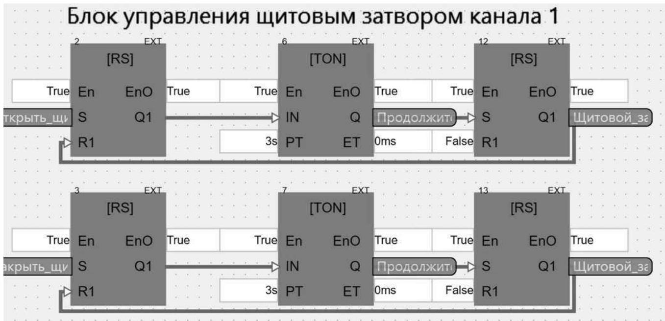
Рисунок 6.2 – Часть программы автоматизации щитового затвора 1 на FBD
