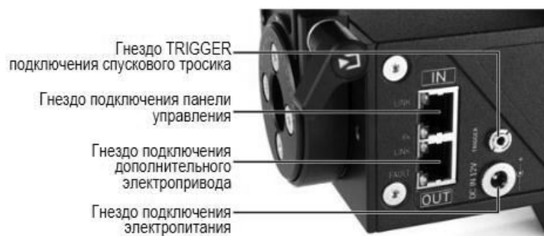
Рисунок 8.2 - Порты подключения моторизированной головы [12]
