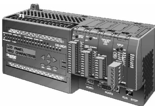
Рисунок – 2.3 Внешний вид контроллера *Direct LOGIC 06*
