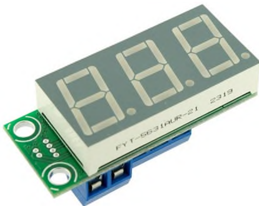
Рисунок 13.5 – Семисегментный индикатор температуры
